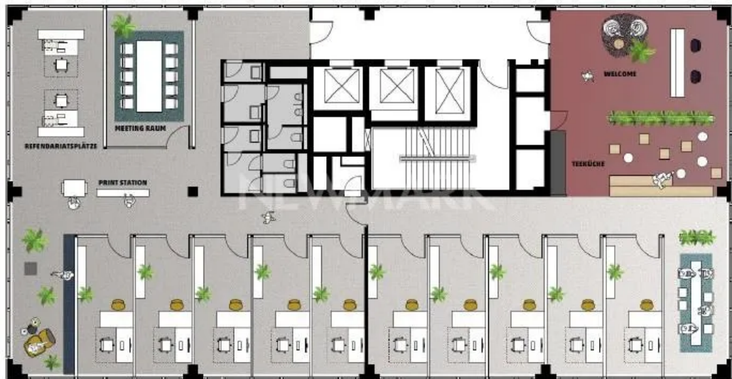
Regelgeschoss Turm, ca. 500 m 2 - Zellenstruktur
